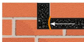
An **Fugenecken** darf das Band nicht am Stück verlegt werden. Ecken ebenfalls gestaucht anlegen.
